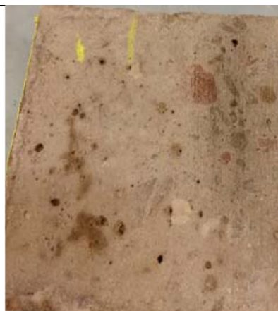
Figur 7.7 Exempel på brottyta hos spjälkad kub där ett tunt lager av bruk kan skönjas i zonen mellan de två betongerna, Cyron (2022).
