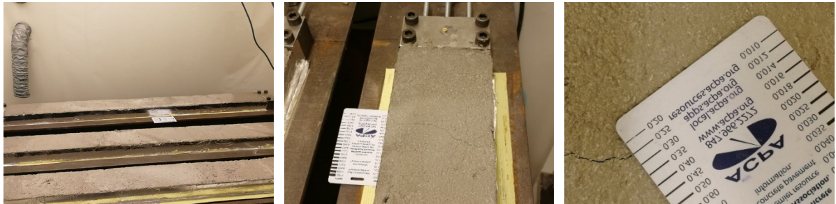
Figur 6.6 Krympande prismor i klimatrum fastlåsta i underliggande stål balkar. Ensidig uttorkning, Geometri och form a), betong och sprickor b).
